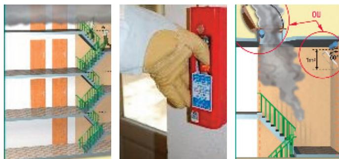
Le système de désenfumage permet l'évacuation des fumées en vue d'une évacuation contrôlée par les secours ou la purge des poches de gaz chauds. Il est composé d'un boîtier de commande au RDC, d'une tringlerie traversant les étages et d'un exutoire de 1m<sup>2</sup> en partie haute de la cage.
